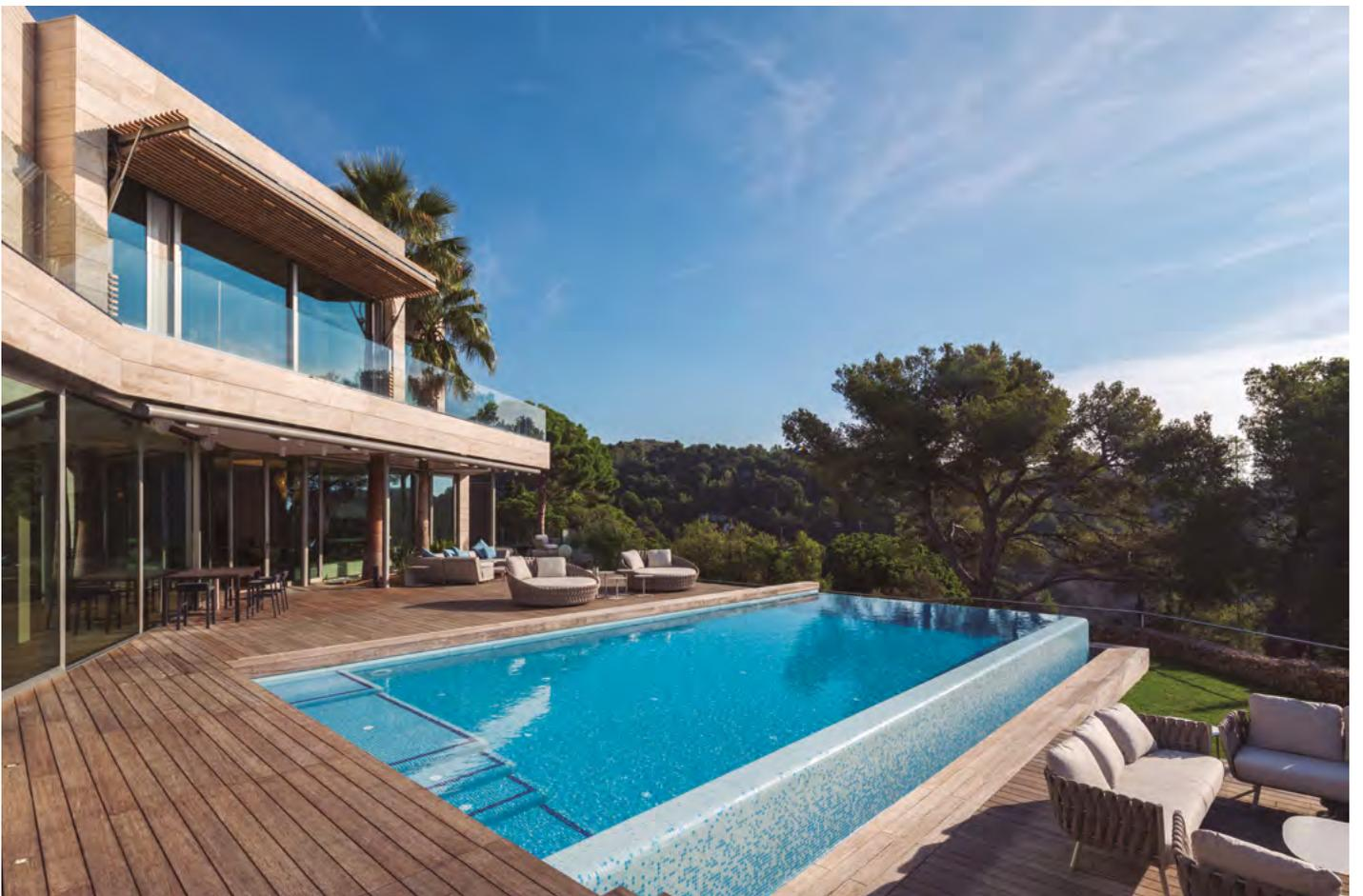
Hunter Douglas y su alianza con MOSO incorporan a la línea residencial el deck de Bamboo X-treme el cual está fabricado en base a fibra de bambú termo tratada que lo hace apto para la instalación al exterior, su tratamiento de alta densidad le da a la lama de bambú una estabilidad dimensional, durabilidad y una excepcional dureza, superior a las mejores especies de maderas tropicales.
