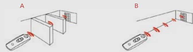
RF TELIS 1: Emisor monocanal capaz de operar solo un motor independientemente; sin embargo se pueden agregar varios motores a este monocanal funcionando todos a la vez.
