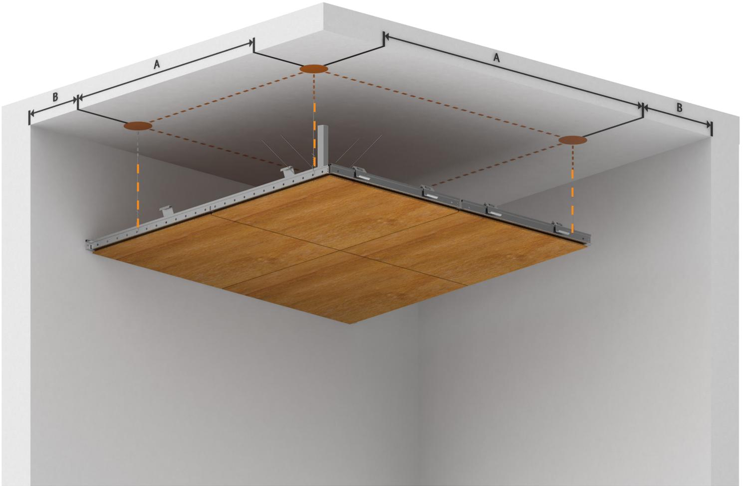
1. Planificar el diseño de la cuadrícula y marcar la ubicación de los puntos de suspensión sobre la losa según proyecto.
