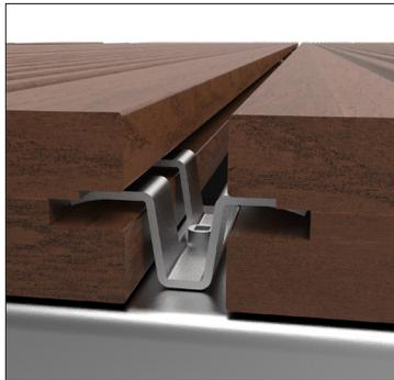
Montar las tarimas de bamboo sobre los perfiles omega fijando el clip de instalación que se sitúa entre los paneles, de esta forma se sostiene el entarimado y se preserva la cantería transversal de 6mm entre paneles.
