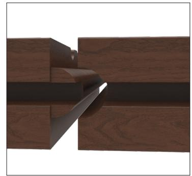
El montaje de las piezas en el sentido longitudinal se hará a través de un encaje machihembrado entre los paneles.
