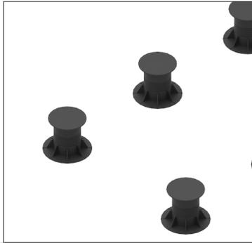
Trazar una grilla con módulos de 450mm x 600mm para posicionamiento de Plots que serán la base de la estructura. Luego disponer los plots según la medida de la grilla sobre el suelo previamente compactado y nivelado. Fijar sobre la superficie existente o palmetas dispuestas especialmente para su instalación.
